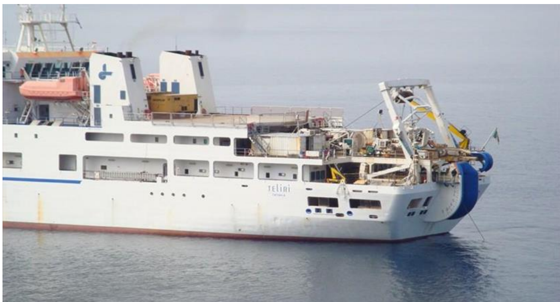
Fig. 12: Navio de instalação do cabo submarino com ponte-grua à popa, enquanto procede à largada do cabo pela borda.
