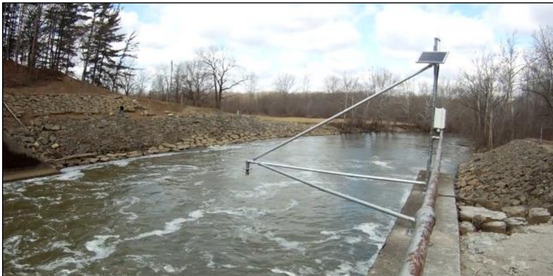
Figura 3 – Colocação do sensor perpendicularmente ao fluxo do canal.
