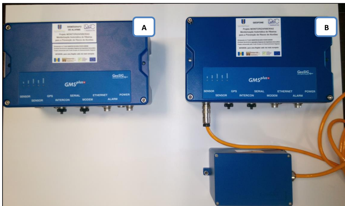
Figura 5 – Sensores de vibração do Sistema MonitorizaRibeiras: Acelerómetro (A) e Geofone (B).
