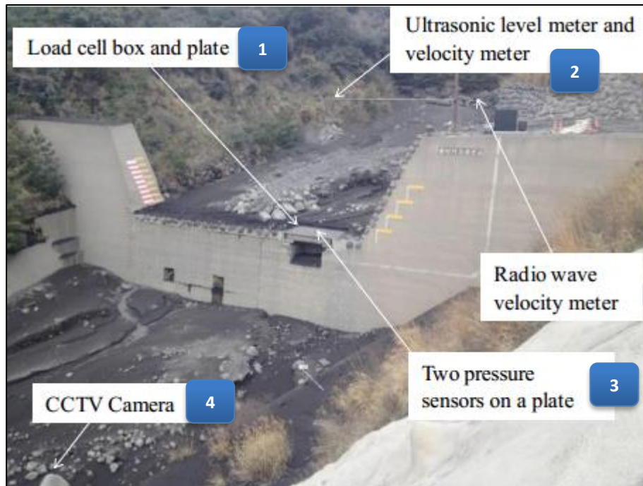
Figura 15 – Sistema de monitorização composto por células de carga e uma placa em aço (1), um sensor ultrassónico e um sensor de velocidade (2), sensores de pressão (3) e uma câmara de vídeo (4) (Osaka, Utsunomiya, Tagata, Itoh, & Mizuyama, 2014).
