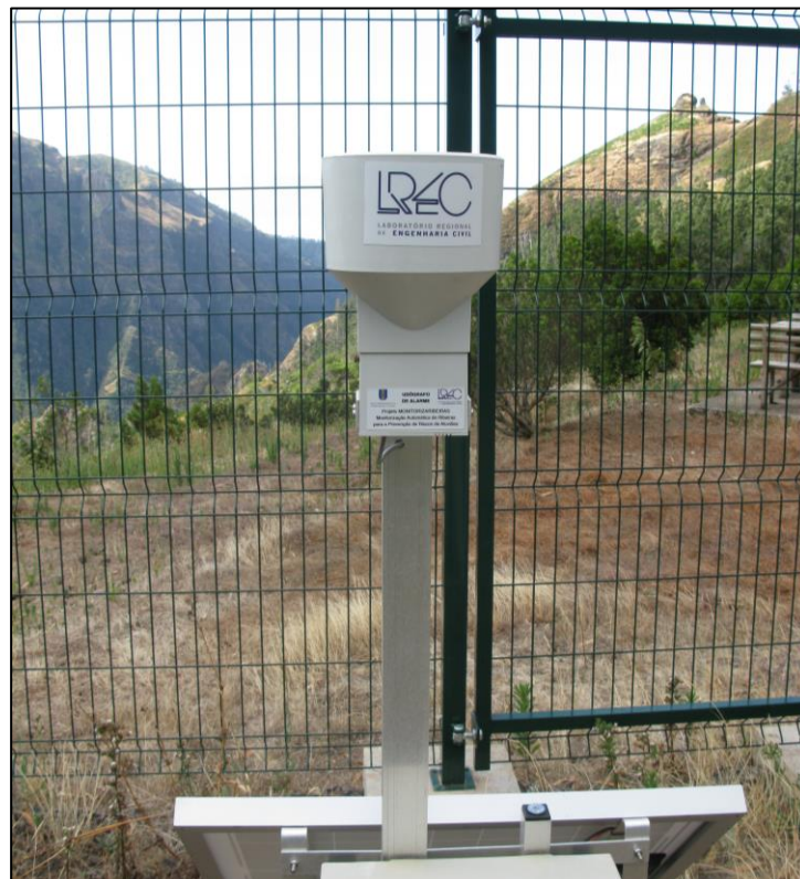
Figura 6 – Udógrafo de alarme do Sistema MonitorizaRibeiras.
