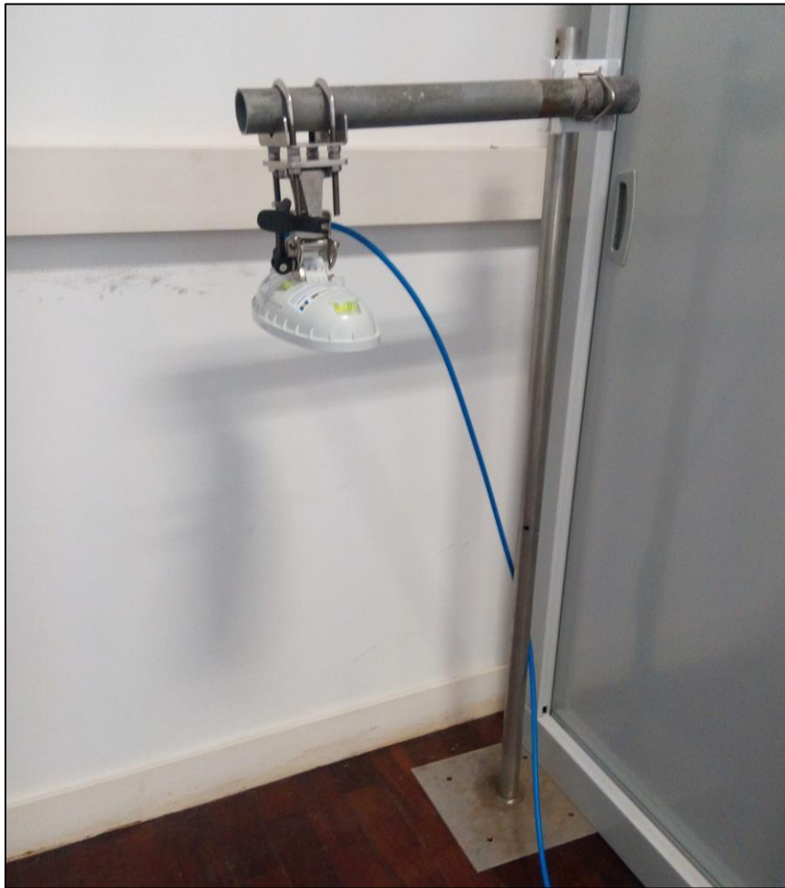
Figura 4 – Sensor de nível com tecnologia de radar do Sistema MonitorizaRibeiras.
