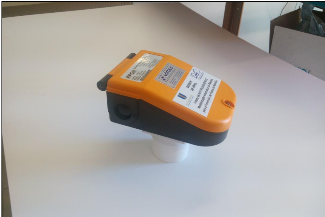
Figura 2 – Sensor de nível ultrassónico do Sistema MonitorizaRibeiras.
