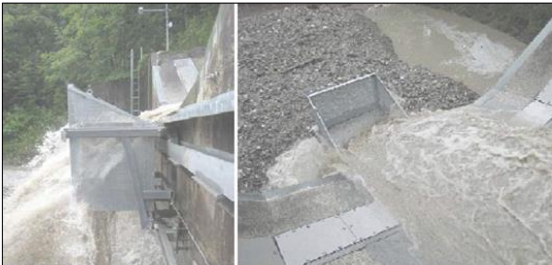
Figura 14 – Sistema de Basket Samplers (Rickenmann, Turowski, Fritschi, Klaiber, & Ludwig, 2012).
