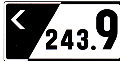
01b – Demarcação hectométrica da via – IC
