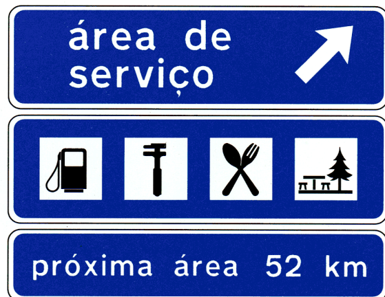
14b – Aproximação de via de saída para área de serviço
