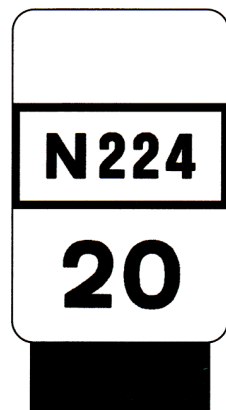
03d – Demarcação miriámetrica da via – restantes estradas
