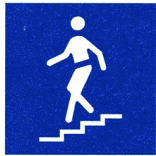
2.24 – Passagem desnivelada para peões com escada
