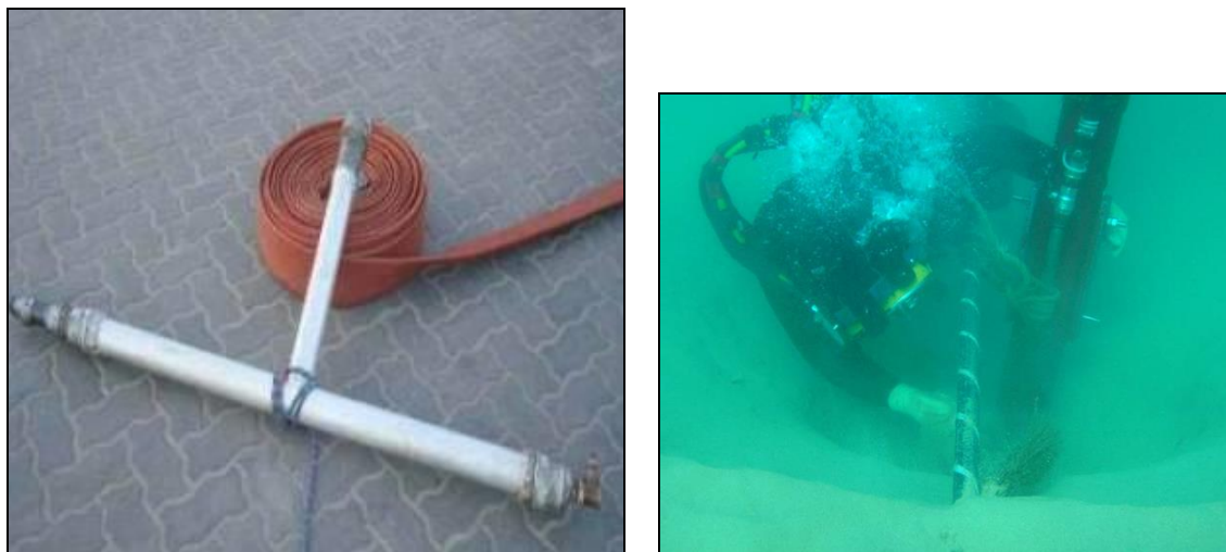
Figura 11 A e B: Ferramentas de mergulho para enterramento
