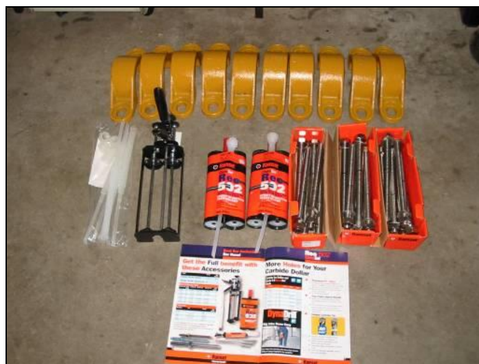
Figura 14: exemplo dos kits das braçadeiras do cabo
