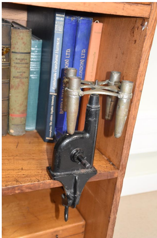
Fig. 8 Centrífuga manual com suporte para 4 tubos
