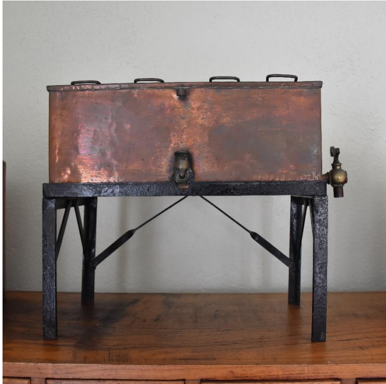
Fig. 5 Banho-maria em liga metálica de cobre com pés de ferro e orifícios expostos para os tubos
