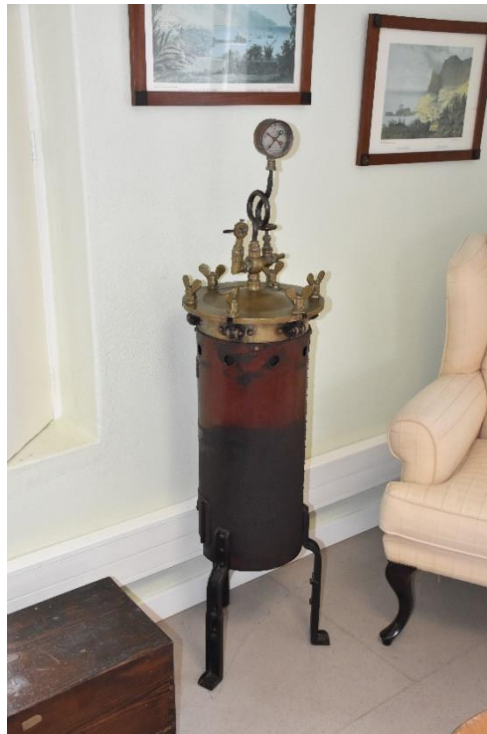
Fig. 2 Autoclave vertical (com 3 pés e manómetro, fechado com 6 parafusos de “orelhas” – F&M Laufensher)
