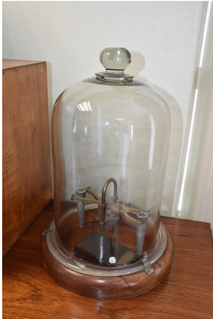
Fig. 4 Centrifuga Manual em campânula de vidro
