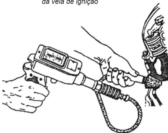
Fig.7.11 – Utilização de um compressógrafo com adaptador
