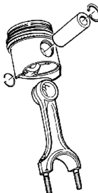
Fig.2.25 – O cavilhão faz a ligação entre o êmbolo e a biela
