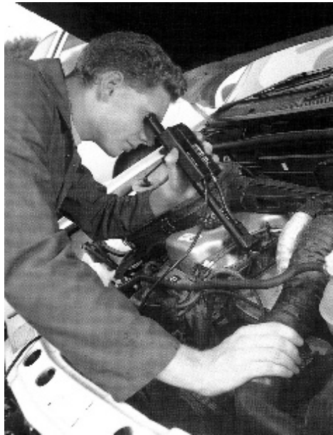
Fig.10.3 – Inspeção de uma câmara de combustão com um endoscópio
