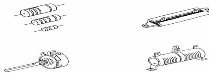
Fig. 3.9 - Configurações de resistências
