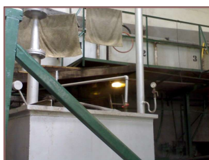
Fig. AIII.7 – Clarificação - cozedura da guarapa para eliminação de substâncias estranhas e corantes e facilitar a inversão da sacarose.
