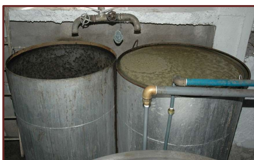
Fig. 10 – Clarificação do sumo de cana
