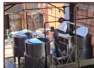
Fig. AIII.12– Evaporadores ou Tanques de concentração do "caldo de cana"
