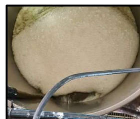
Fig. AIII.9 – Tanques de pré-aquecimento para clarificação e floculação das impurezas
